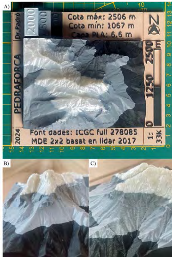
A) Vista nadiral del model sobre una base per mesurar (unitats cm). B) Detall oblic de l'enforcadura des de l'est (es poden observar les isolínies). C) Detall oblic del Pollegó Superior des del nord-est (es poden observar les isolínies). Font: Elaboració pròpia. Noti's que hi ha elements cartogràfics essencials com l'escala gràfica, l'escala numèrica, la indicació de nord, l'escala vertical amb els intervals d'altitud simbolitzats, les cotes mínima i màxima i la font de les dades. Fotografies: Miriam Corrius Mujal.
