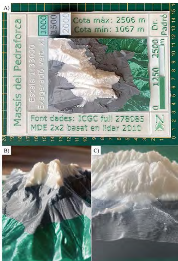
Figura 18. Materialització del MDE del Pedraforca en impressió 3D (versió amb simbolització hipsomètrica verd-gris-blanc a intervals de 500 metres)
